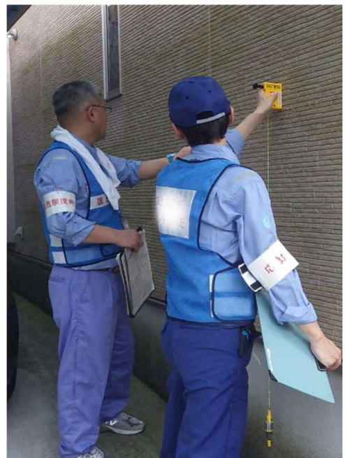
下げ振りを使用し壁面の傾斜を測っている様子。(熊本地震デジタルアーカイブより)下げ振りの使用方法については、判定士だより(2023年版 VOL30)の2ページをご覧ください。
