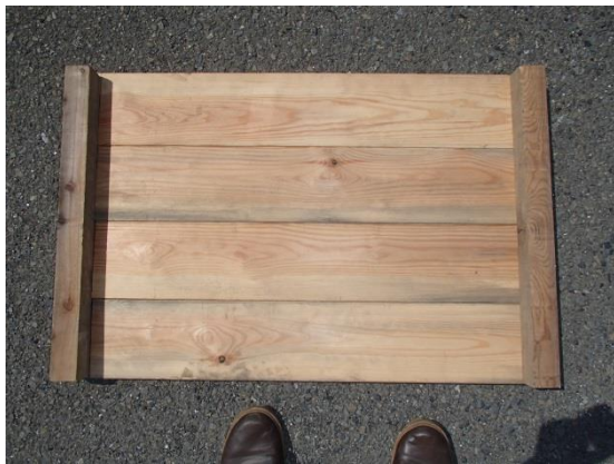
本体用材料(1)板①と(2)角材①をネジで固定。
